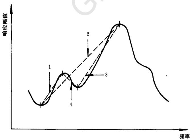
图 2 几对峰谷及频率比的确定
