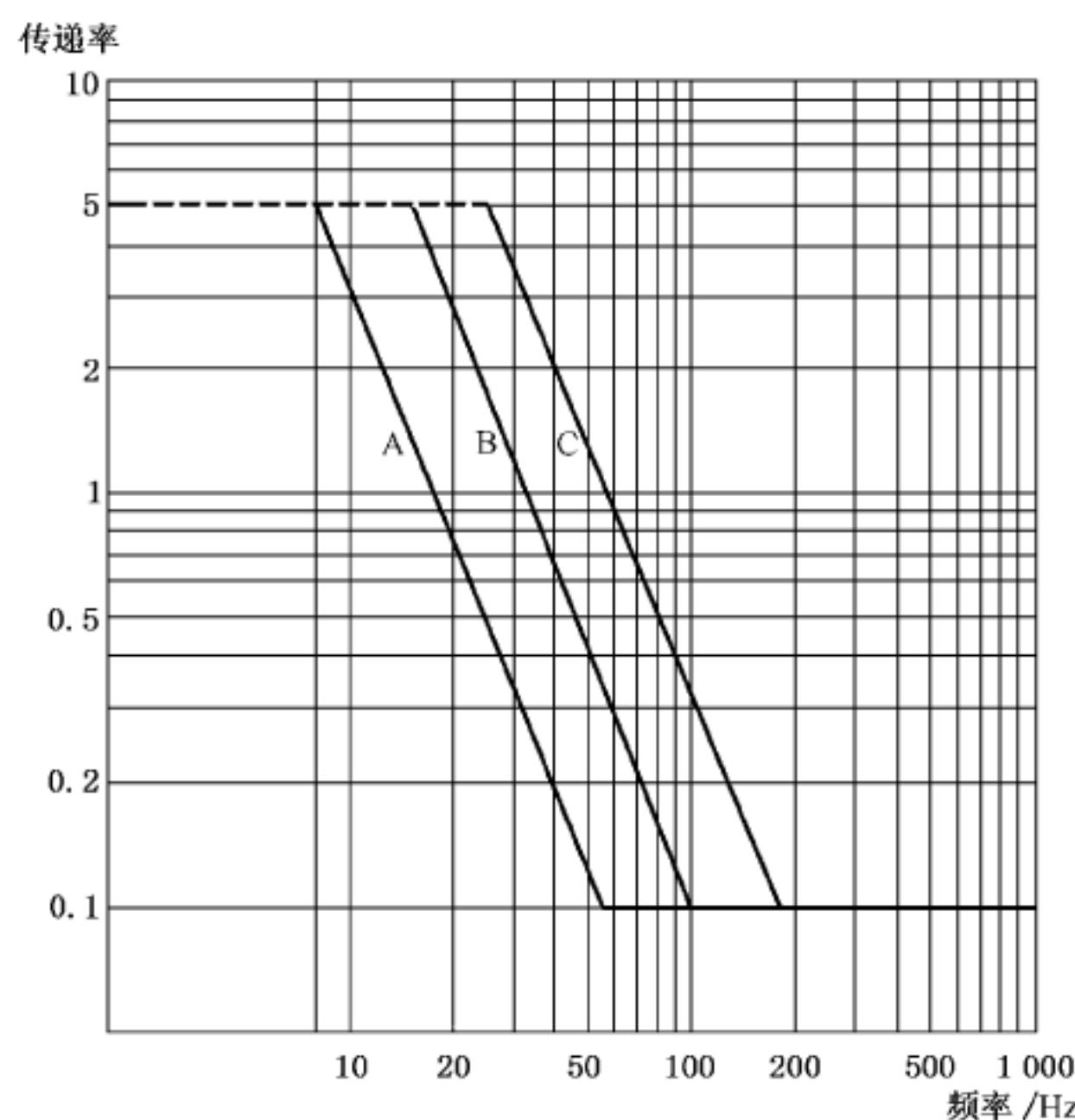
图 A.1 减振器的一般传递特性曲线
