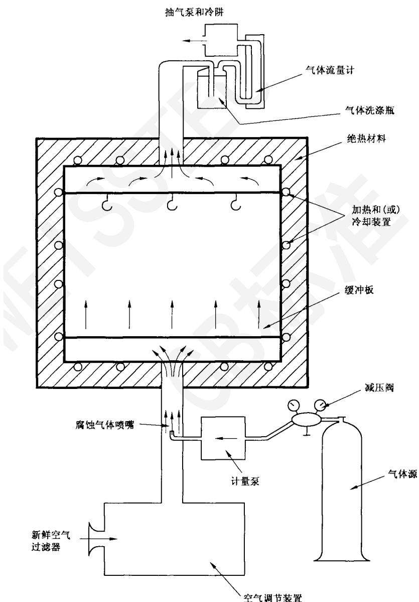
图 A.1 带气体发生的装置示意图
