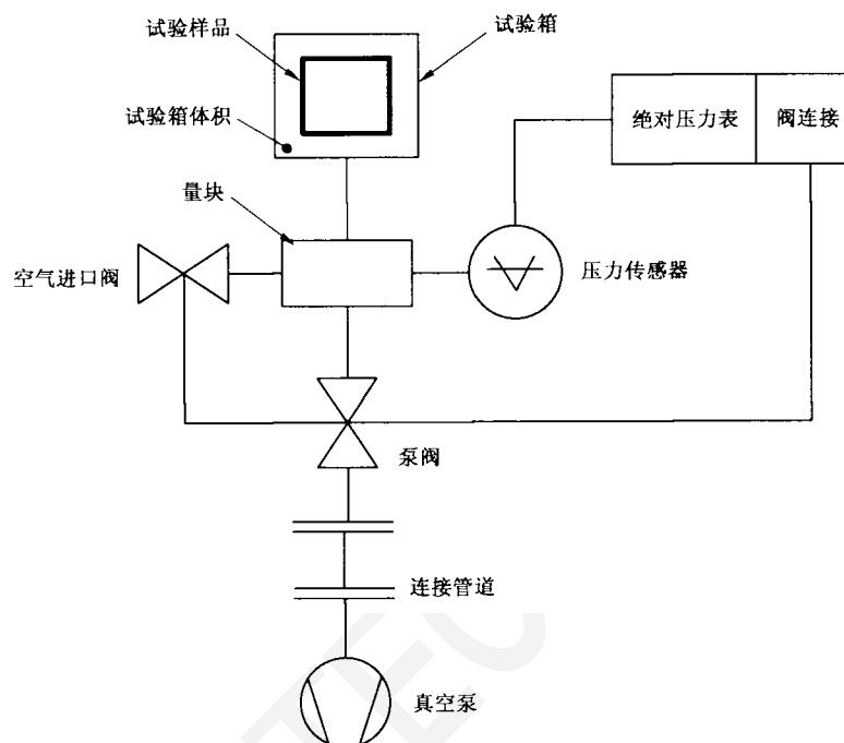
图 2 增压密封试验典型安装
