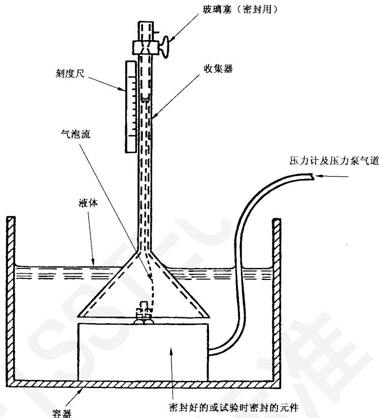
图 A.2 (试验 Qa) 密封试验设备
