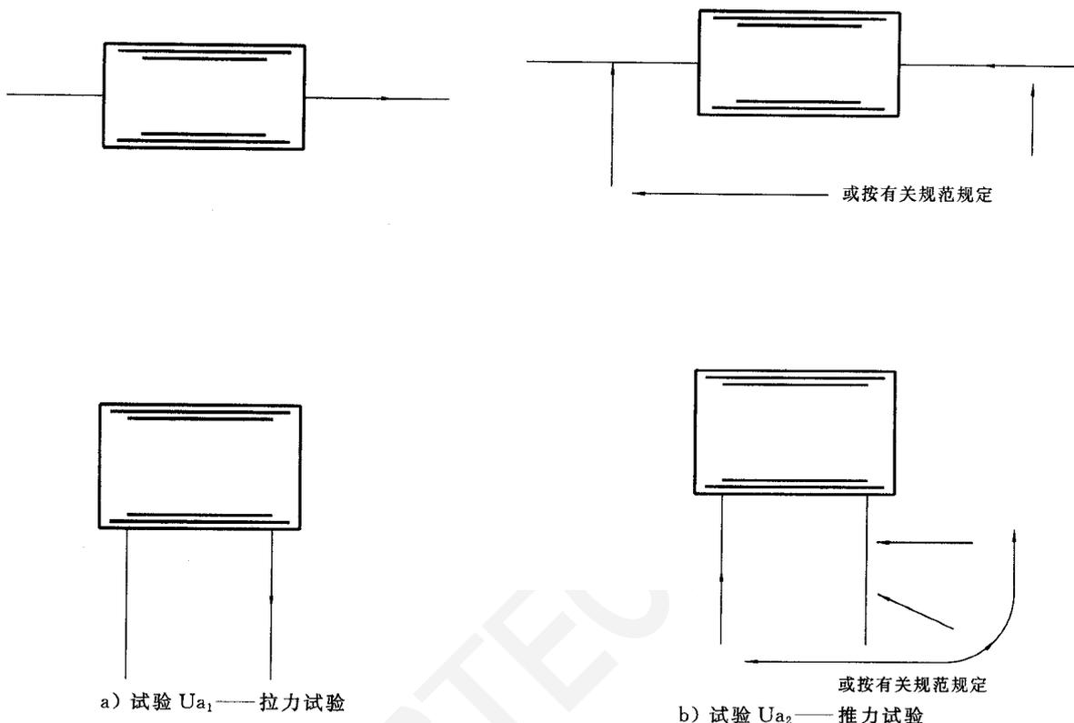
图 1 用箭头表示力的施加方向的示意图
