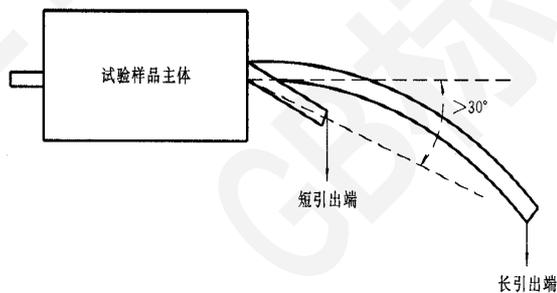
c) 可弯曲引出端的位移角示意图
