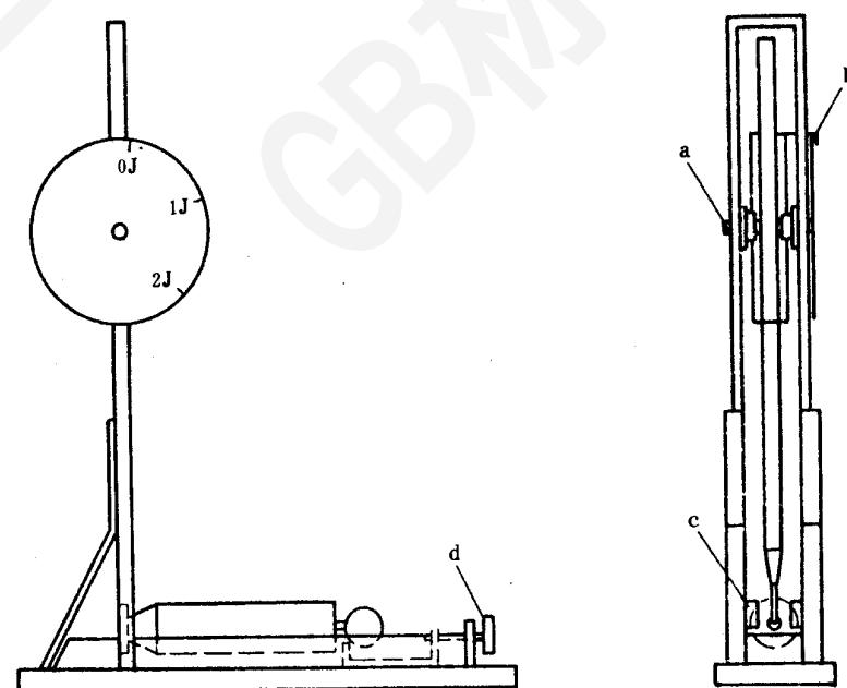
图 A3 校准装置
