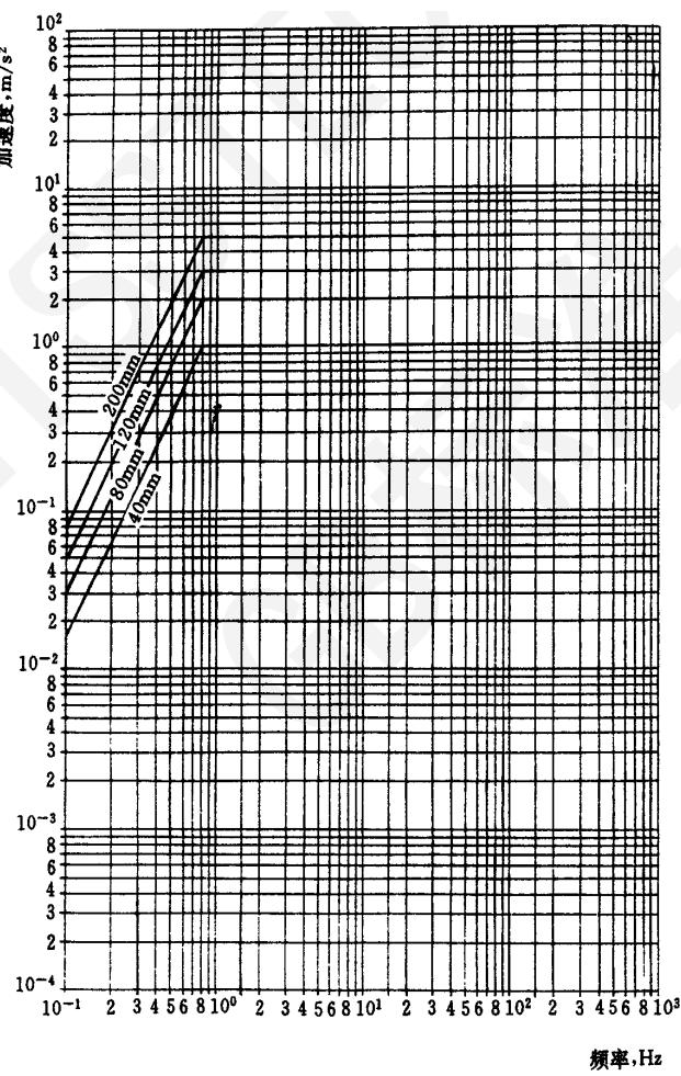
图 2 0.8 Hz 交越频率时的推荐幅值
