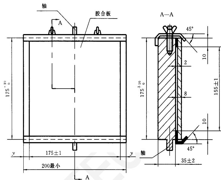
图 3 安装夹具
