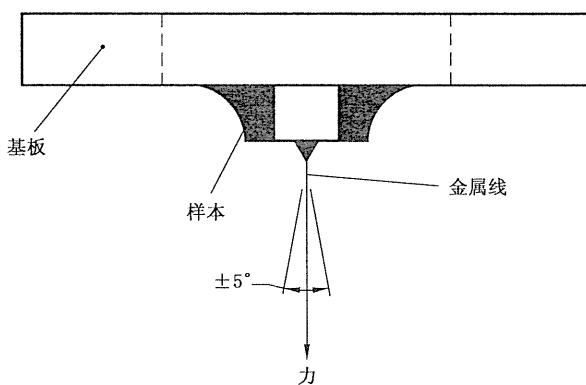
图 9 试验 Ue2:推脱试验
