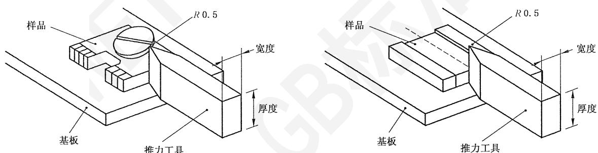
注：当样品的长度小于等于 2.0 mm 时，推力工具的半径为 0.2 mm。
