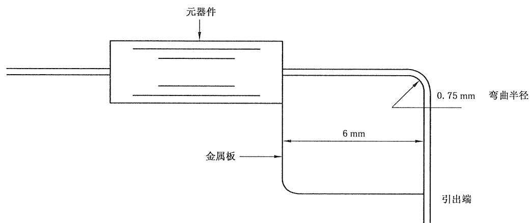
a) 扭转试验铅线弯曲试验
