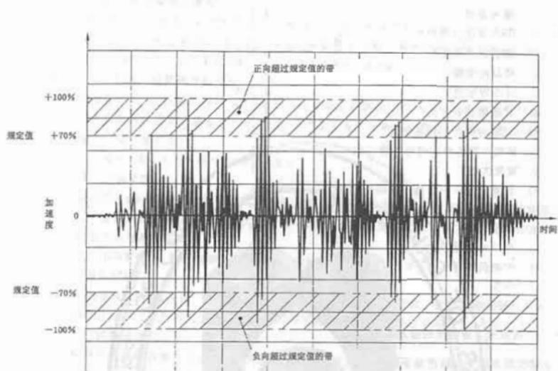
图 1 典型的由特定时间历程激励的响应示例(规定阈值 70%)
