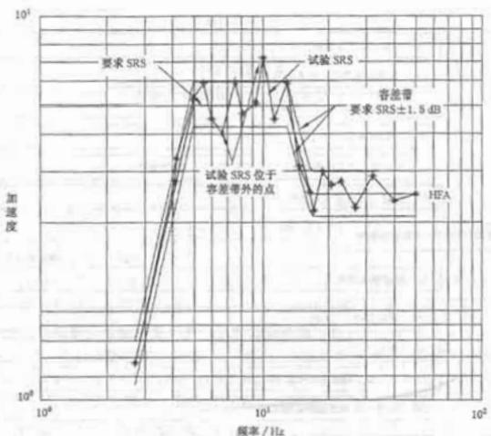
图 3 要求响应谱的典型对数图
