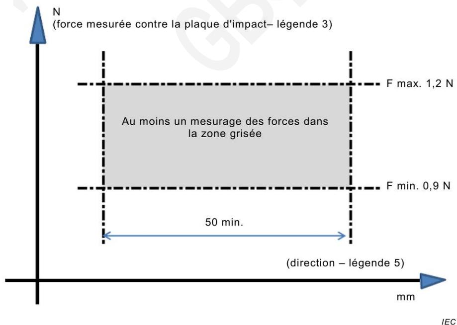
**Figure D.9 – Répartition de la force d'impact**
