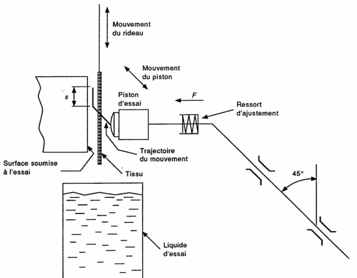
**Figure 1.A – Schéma de l'appareillage d'essai (article 4.1)**
