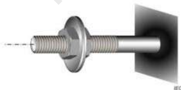
Figure 12 – Préparation d'une sortie fileté pour l'essai de couple
